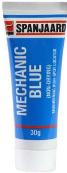
**El localizador de puntos altos de ingeniería es una pasta azul para localizar puntos altos en superficies de contacto como rodamientos y ejes. Los puntos altos se muestran como rayas brillantes al girar el eje en el rodamiento.**
